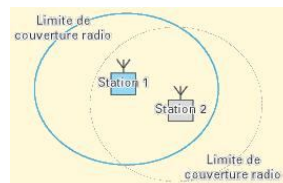
Figure B.1 : réseau ad-hoc minimal
